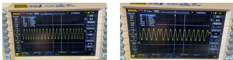
図1 信号の波形（左から、FSK 信号、位相変調した TSP 信号）
