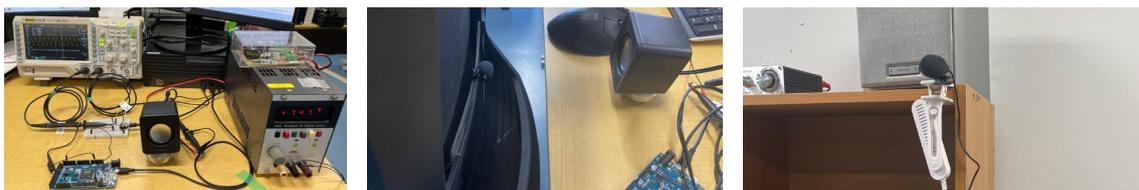
図2 実験の様子（左から、実験装置、スピーカーから 10cm の地点のマイクロフォン、スピーカーから 3m の地点のマイクロフォン）
