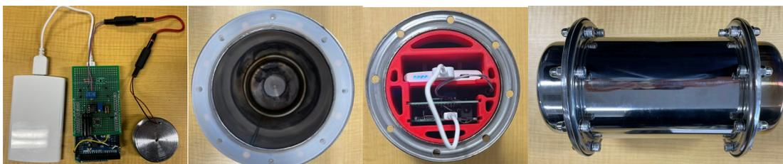
図6 信号発信デバイス(左から、内容物、ロウ接箇所、コンテナ内の様子、外観)
