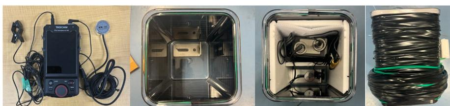
図7 信号受信デバイス(左から、内容物、金物の配置場所、コンテナ内の様子、外観)
