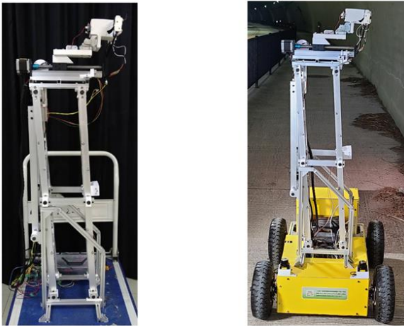
図 3 実装したマニピュレーター(左)と搭載状態(右) Figure 3 Mounted manipulator (left) and mounted state (right)
