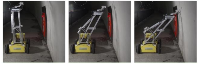
図 5 マニピュレーターの傾斜の様子 Figure 5 View of Manipulator Inclination
