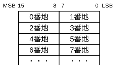
図 1 本実験で設計している RISC マシンのバイトオーダ
